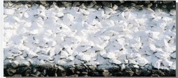
滚涂涂料显微镜下结构
