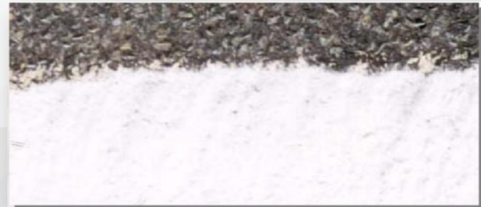
机喷涂料显微镜下结构
