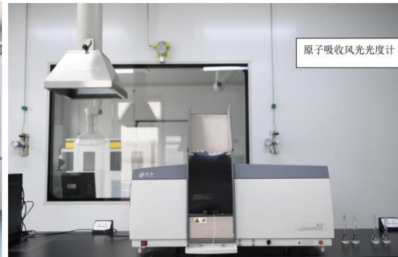
原子吸收仪：检测重金属、微量元素
