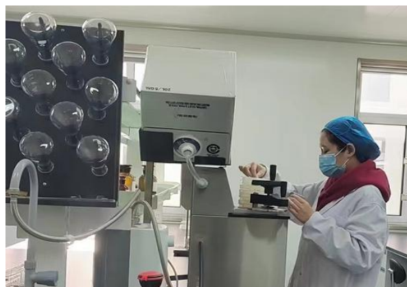
纤维仪：粗纤维检测
